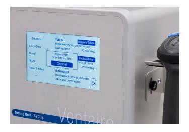
Para repetir una notificación, toque "Allow snooze reminders" (Permitir repetición de recordatorios). Para exigirles a los usuarios que escaneen el código de barras de su placa de identificación para desestimar la pantalla de notificación, toque "User barcode required to dismiss" (Se necesita código de barras de usuario para desestimar).
