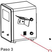
Use el destornillador para ajustar el tornillo trasero hasta que ambos tornillos estén bien ajustados.
