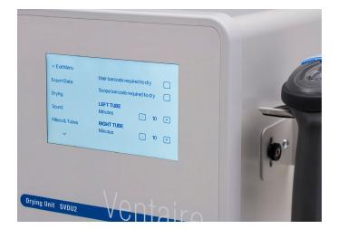
La unidad de secado viene configurada con ajustes predeterminados de duración de secado, pero es responsabilidad de quienes usen el sistema determinar las duraciones de secado en función de las pautas de la organización o las pautas del fabricante de endoscopios.
