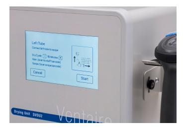
Para modificar la duración del ciclo de secado, el usuario puede tocar "+" o "-" hasta alcanzar la duración deseada y después tocar "Start" (Comenzar) o escanear de nuevo el código de barras de la placa de identificación o del endoscopio para iniciar el secado.
